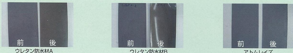
ウレタン防水材は表面劣化、変色が大きく、強度・伸び保持率の低下が大きいが、アトムレイズは、表面劣化、変色が少なく、強度・伸び保持率が安定。長期間安定した物性、性能を維持します。
