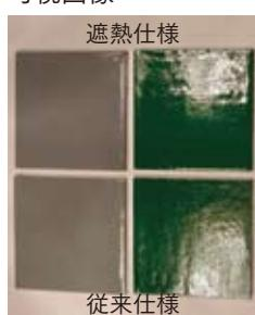
\*レフランプ(160W, 高さ30cm, 10分)照射時のサーモグラフィーによる表面の温度分布を測定しています。
