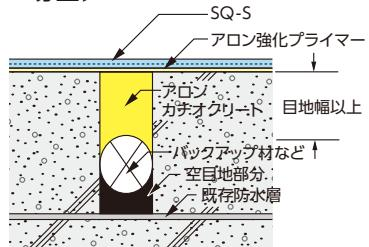
伸縮目地処理例(脱気筒を併用します) ※施工前に吸引機で水を除去すること
