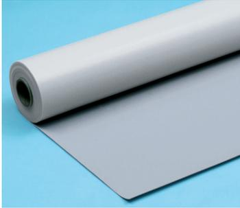
紫外線を遮断するMMA樹脂層を積層しているため、長期の変退色が少なく、また耐熱性能に優れています。ポリエステル樹脂製の補強クロスが積層されているため、優れた引張・引裂強度を実現。特に柔軟性に優れ、繰り返し疲労に対して優れた性能を示しており、LCS工法に適しています。
