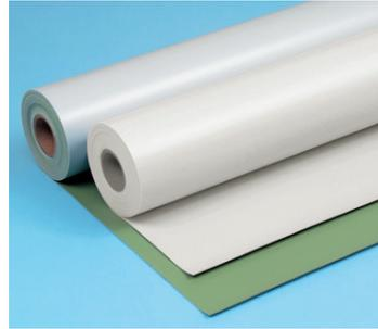
リベットルーフCOOLは、太陽光を効率よく反射し屋上スラブへの蓄熱を軽減させます。特殊顔料(着色剤)を配合しているため、赤外線波長領域の光を効率良く反射します。また、ポリエステル樹脂製の補強クロスを積層しているため、優れた寸法安定性、引張・引裂性能を実現します。
