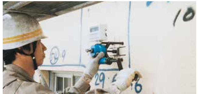
〈ボンドピンニング工法の補修効果確認例〉
